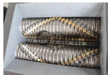
Se recomienda la serie SRSF para desgarrar film a menor tamaño para los posteriores procesos de lavado y extrusión de granza si lo requiere sus equipos auxiliares.
